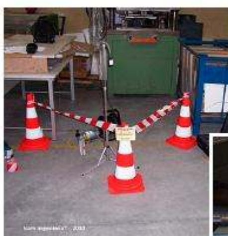
Muestreo ambiental de punto fijo para comprobar el correcto mantenimiento de los MCA (materiales con amianto), verificando que no se produce una liberación importante de fibras de amianto al ambiente.
