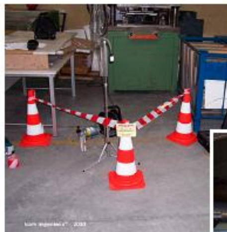
Muestreo ambiental de punto fijo para comprobar el correcto mantenimiento de los MCA (materiales con amianto), verificando que no se produce una liberación importante de fibras de amianto al ambiente.
